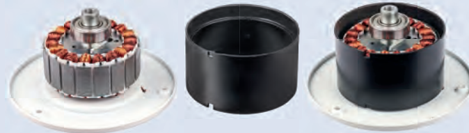
Nuestro motor CC/CE más pequeño y de menor consumo. A la izquierda el estator con los bobinados, en el centro el rotor como imán permanente. A la derecha en estado listo para funcionar.
