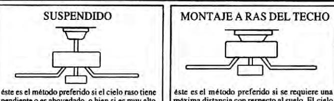
Este es el método preferido si el cielo raso tiene pendiente o es abovedado, o bien si es muy alto, requiriendo el uso de una varilla hueca.
