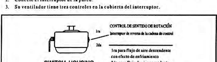
Apague el ventilador y espere que las aspas se detengan antes de cambiar la posición del interruptor deslizante de reversa. El ventilador de techo es una opción interesante tanto para enfriar como para ayudar a calefaccionar su ambiente.
